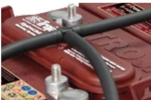
Conexión de acoplador con indicador del nivel de agua
